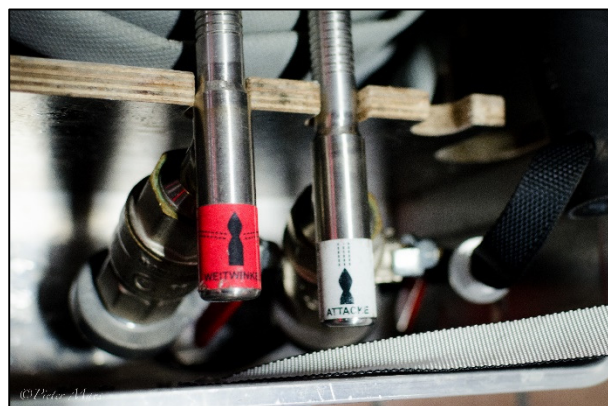
Figuur 7 De gemerkte kop van de piercing nozzles: een rode band voor de restrictor en een grijze band voor de attack. (Foto: Pieter Maes)
