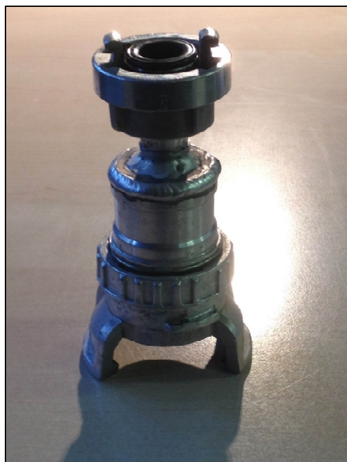
Figuur 11 Overgangsstuk tussen DSP 45 mm (onder) en Storz 25 mm (boven). (Foto: Karel Lambert)
