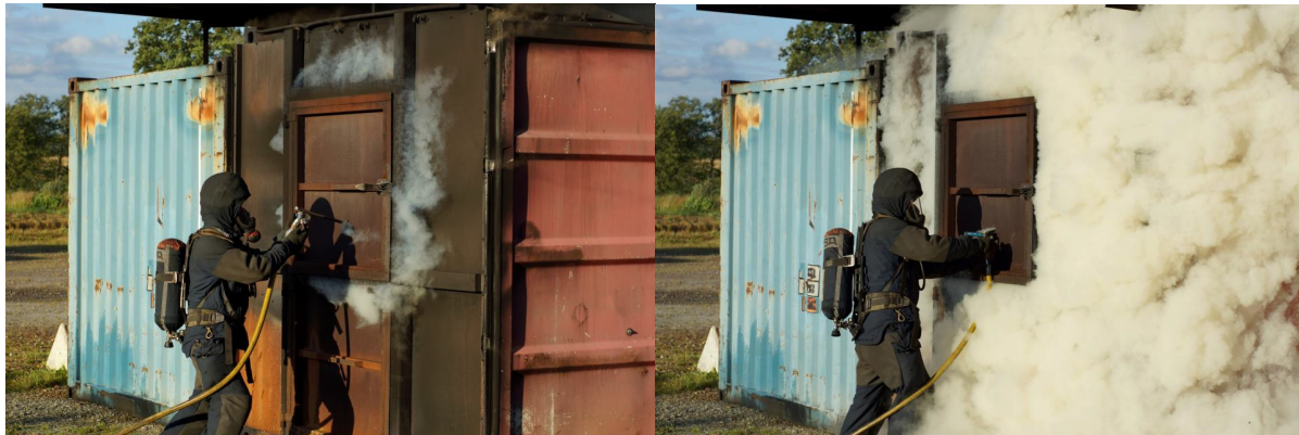
Figuur 8 Toepassing van een piercing nozzle bij een ondergeventileerde brand. Het water dat naar binnen gespoten wordt, zorgt voor afkoeling. Er worden grote hoeveelheden stoom geproduceerd die de ruimte inertiseren. (Foto: Lars Ågerstrand)
