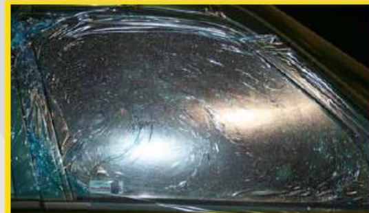
2. Laat vervolgens de ruiten springen die verwijderd moeten worden. Bescherm te allen tijde het slachtoffer.
