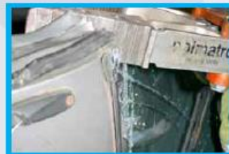
7. De voorruit scheurt nu mooi los over de kitnaad (weinig splinters en stof van de voorruit).
