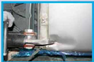
5. Knip aan de onderzijde het dak haaks in (achterzijde/ voorzijde).
