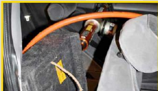
1. Creëer een afzetpunt om de ram of spreider te kunnen plaatsen.
